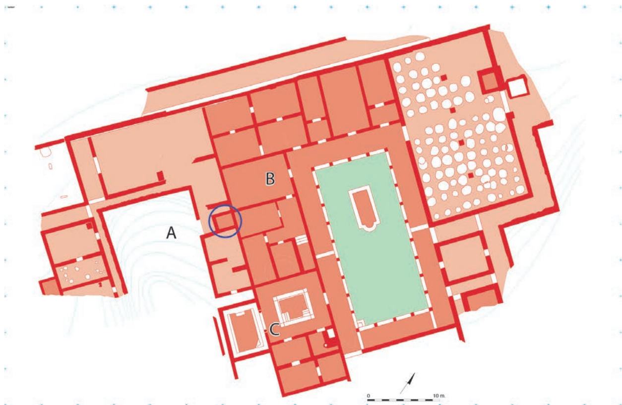
Figure 2. La villa du Haut-Empire et la localisation du chauffage par convection. A, cour secondaire, logements des dépendants ; B, aile occidentale de la résidence ; C, bains.
