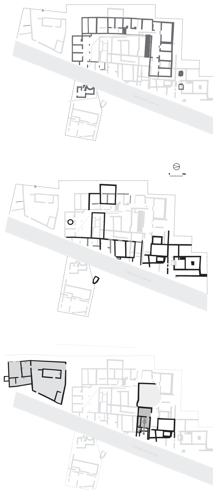
Figure 4. Plans des trois états du site de la villa romaine de Vilauba, Camós, Pla de l'Estany.
