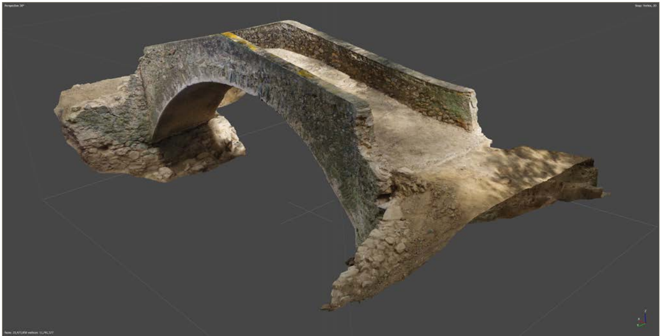
Figura 1. Vista del pont, en 3D, obtinguda en els treballs complementaris de fotogrametria (foto Pau Castillo).
